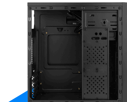
ESPACIO INSTALACIÓN PARA HASTA 3 VENTILADORES
