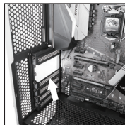
Remove PCI slot / Retira el slot PCI.
