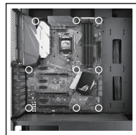
Fix M/B screws / Fija la placa base con tornillos.
