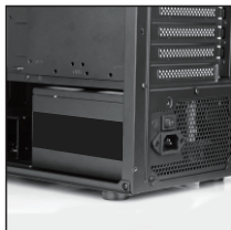
Install power supply location / Instala la fuente de alimentación.
