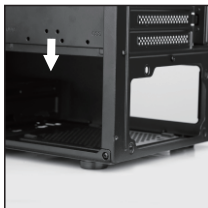
Power supply location / Localización de la fuente de alimentación.
