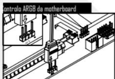
A) Se a sua motherboard possuir algum sistema de iluminação ARGB, ligue o adaptador do hub ARGB na mesma, certificando-se que o pino indicado com uma seta está ligado ao pino de 12 V na motherboard.
