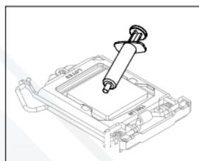
2) Aplica una fina capa de pasta térmica en la superficie del microprocesador.
