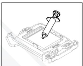
2) Aplique uma fina camada de massa térmica na superfície do CPU.
