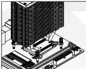
3) Coloca el disipador sobre el microprocesador, apretando los tornillos del soporte en la placa posterior para asegurar el disipador firmemente.
