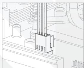
Conecta el cable 4pines del ventilador a la placa base donde ponga "CPU\_FAN".
