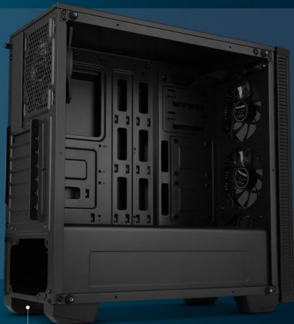
Filtro antipolvo en la entrada de aire de la PSU
